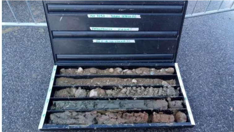
Foto 1: cassetta catalogatrice sondaggio MW1 da 0,0 a 5,0 m
